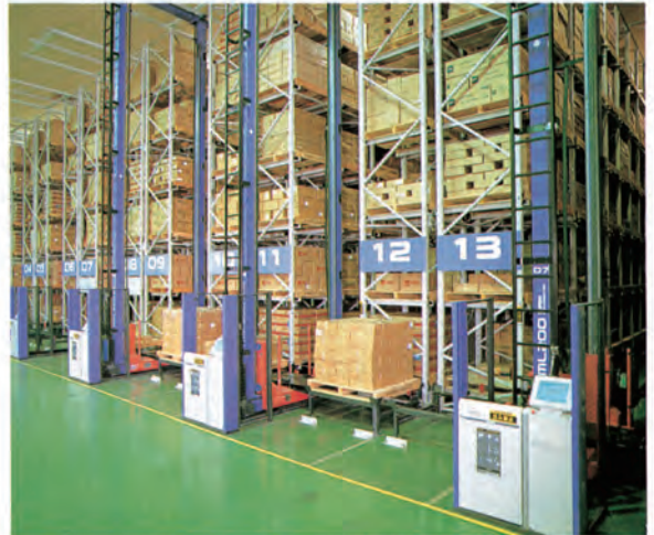
■ 立体自動倉庫
